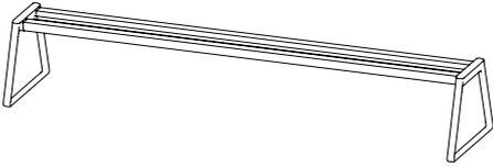
Marco estructural con patas para banco de 4 plazas. El marco está fabricado con 2 perfiles de aluminio extruido de alta resistencia y las patas están fabricadas con aluminio inyectado.
