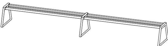
Marco estructural con 3 patas para banco de 6 plazas. El marco está fabricado con 2 perfiles de aluminio extruido de alta resistencia y las patas están fabricadas con aluminio inyectado.
