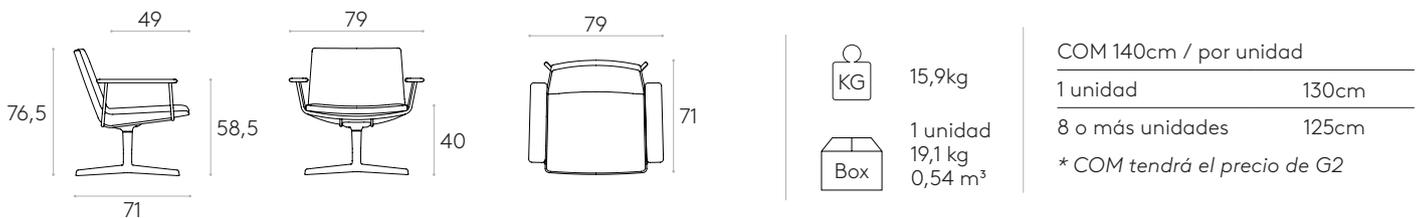
**Butaca con respaldo bajo, base giratoria de 4 radios de aluminio y brazos de madera (tapicería soft)**
